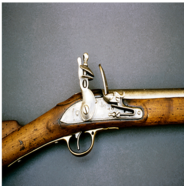
Figura 7 - Espingarda Brown Bess, pormenor das fecharias do sistema de pederneira e em que o sílex e o mordente de chumbo não estão colocados.
