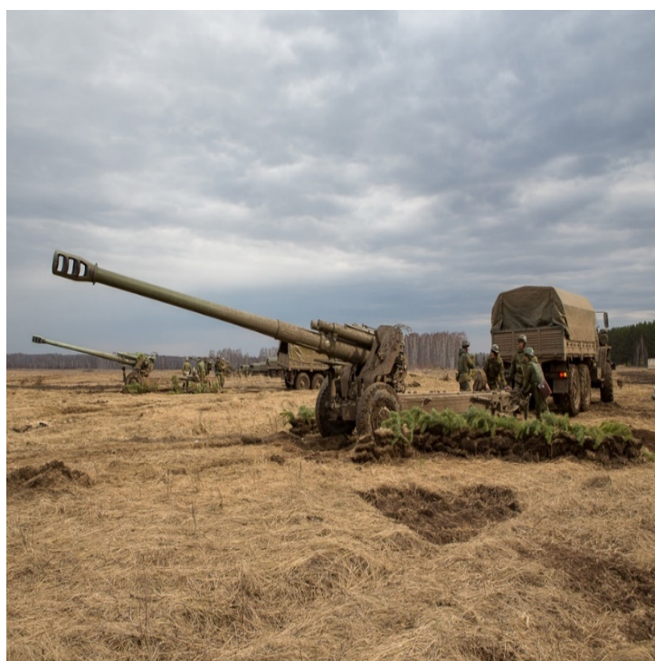
Figura 8 - Peça 2A65 Msta-B calibre 152 mm da Rússia.
