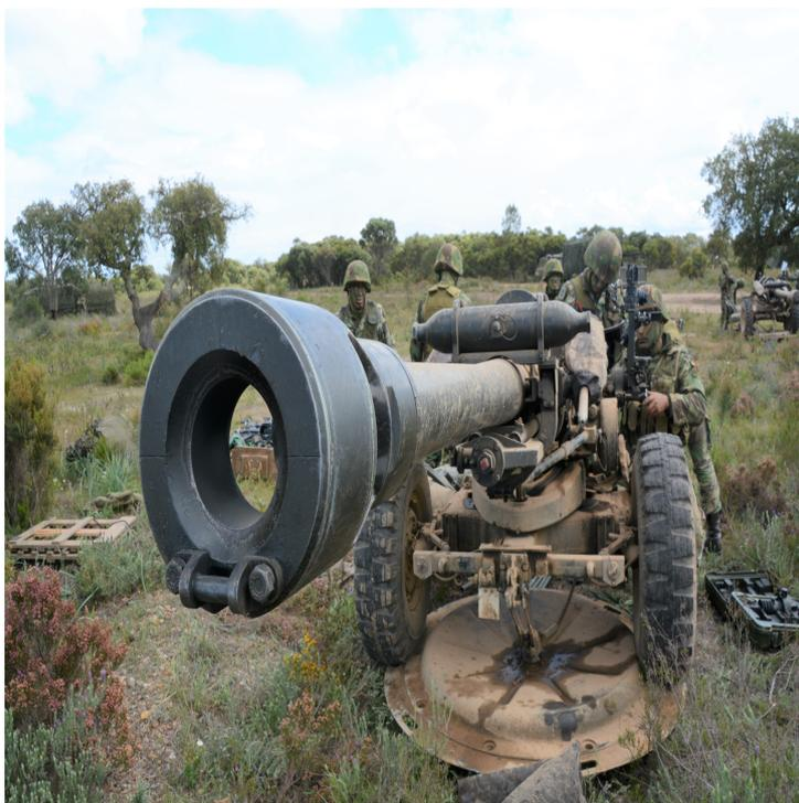
Na Brigada Aerotransportada Independente, os morteiros pesados em uso no CTP foram substituídos pelos obuses M119 Light Gun 105mm que pode ser rebocado, helitransportado, aerotransportado ou lançado em paraquedas.
