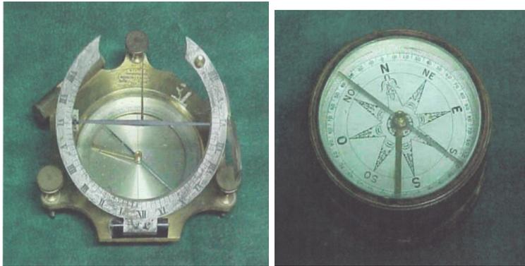
Figuras 9.4 e 9.5 - Relógio de sol com bússola e bússola de campo.
