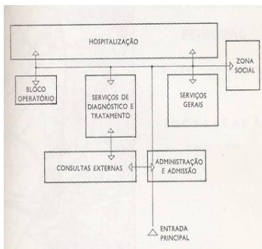
Figura 3 - Esquema de Interligação dos Serviços
